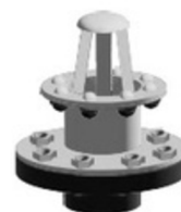
Vidange par le fond * Bloc bride avec anti-vortex inox boulonné Collet bride PVC-P (raccordement tuyauterie enterrée à coller)
